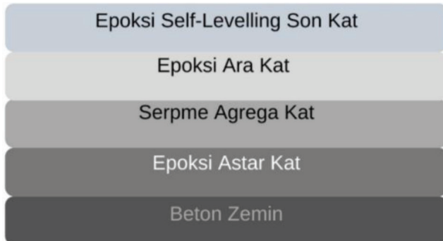
Şekil 2. Epoksi zemin kaplama katmanları
